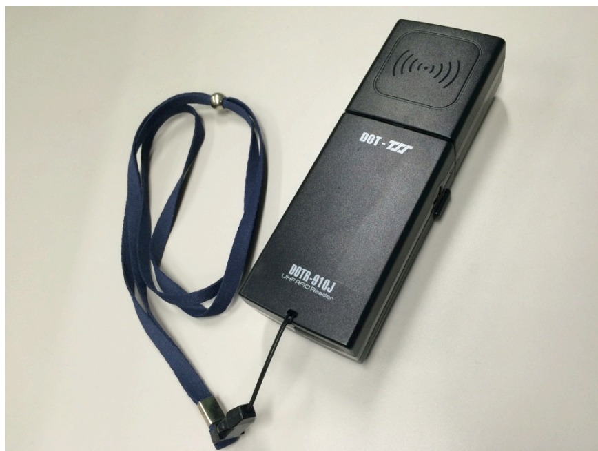
図 4.1 東北システムズサポート社のモバイル RFID リーダ，DOTR-910J。
